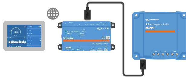
Conexión de la aplicación VictronConnect por LAN o Internet (VRM Portal) con un dispositivo GX (por ejemplo, un Cerbera GX)
